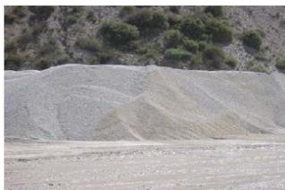
Dado que las mezclas bituminosas abiertas en frío están constituidas por áridos gruesos, formados por la parte del conjunto de fracciones granulométricas retenida en el tamiz 2mm de la [UNE-EN 933-2](#), las condiciones que a continuación se establecen están referidas a dichos áridos gruesos.
